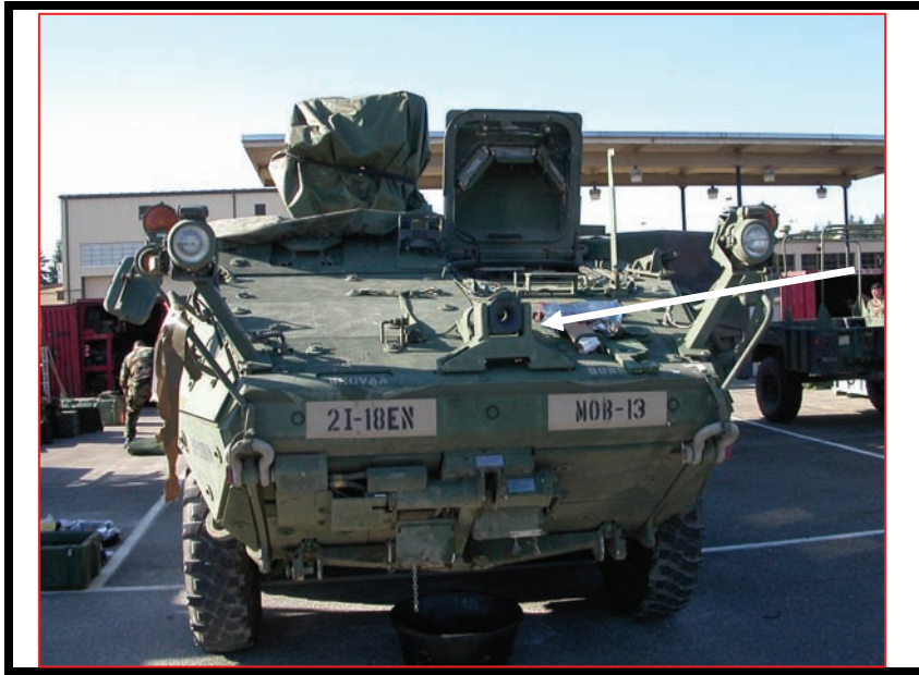
Figure 6-2. DVE sensor location.
